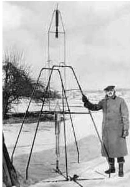
Robert H. Goddard al lado del cohete de combustible líquido en 1926 El cohete está en la parte superior, recibiendo su combustible por dos líneas desde el tanque en la base
