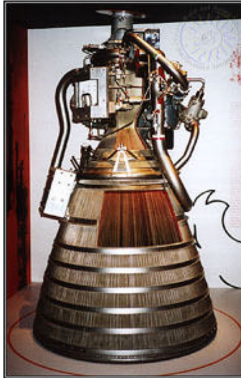
Un motor de cohete en el Smithsonian, con un corte abierto mostrando la tobera convergente-divergente DeLaval
