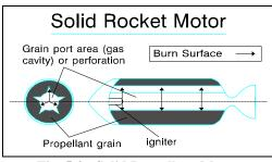
Fig. 5-9. Solid Propellant Motor
