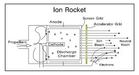
Fig. 5-6. Ion Acceleration
