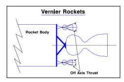
Fig. 5-14. Vernier Rocket
