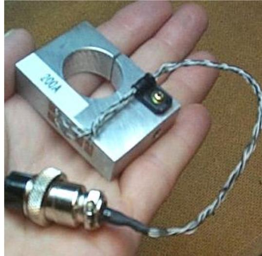
**Figura 5. Célula de carga de 4 sensores de 200 lb**
