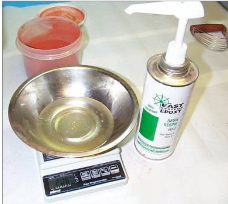
Fig. 1 Pesado de la resina y endurecedor directamente en tazón de mezcla
