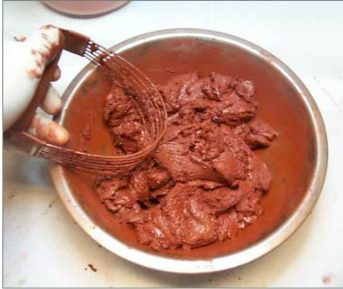
Fig. 3 - Consistencia final de la mezcla de propulsor RNX
