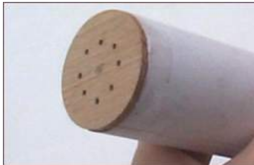
Figura 8 – Disco soporte instalado en el extremo anterior del contenedor del grano.
