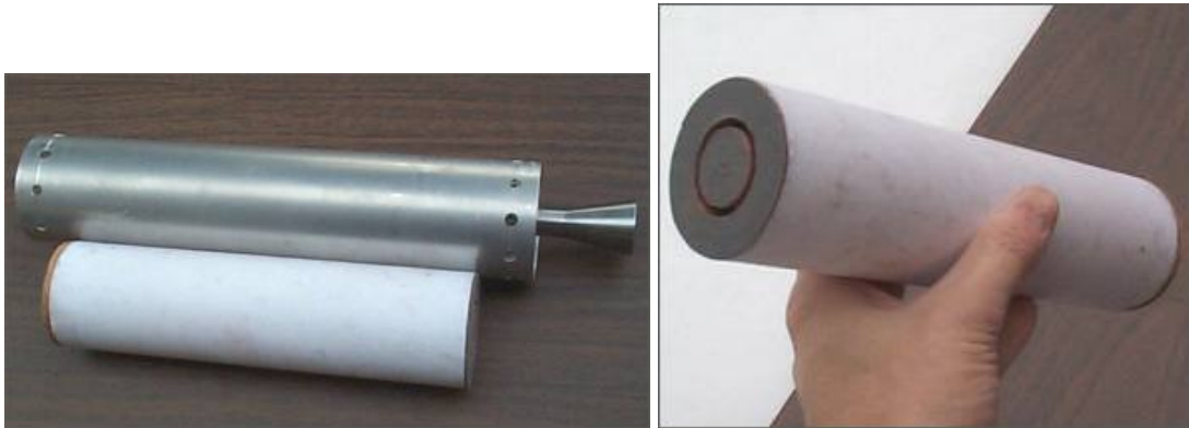
Figura 10 - Paradigma propelente de Barra & Tubo.
