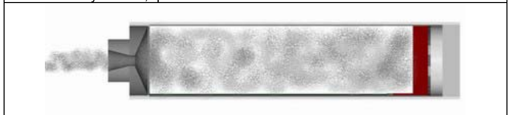
Cuando el combustible se termina, el retardo continúa quemando y haciendo humo blanco que permite seguir el modelo en su trayectoria
